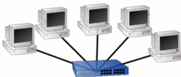
Sternförmiges Ethernet mit Hub
